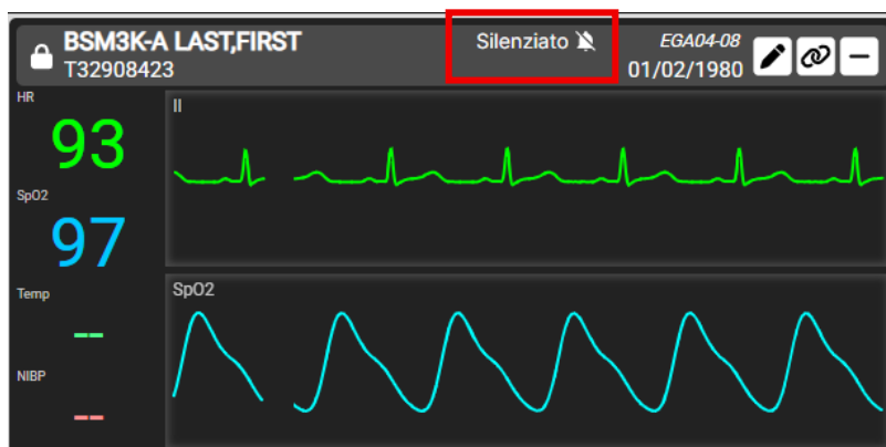
Figura: Tile del paziente indicante lo stato silenziato dell'allarme sul monitor al posto letto.
